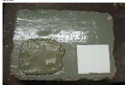
Rozetřená zdicí hmota/sítovina pňdrží v první fázi než dojde k zaschnutí či aplikaci dlaždice atd.
