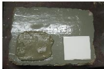
Rozetřená zdící hmota/síťovina přidrží v první fázi než dojde k zaschnutí či aplikaci dlaždice atd.
